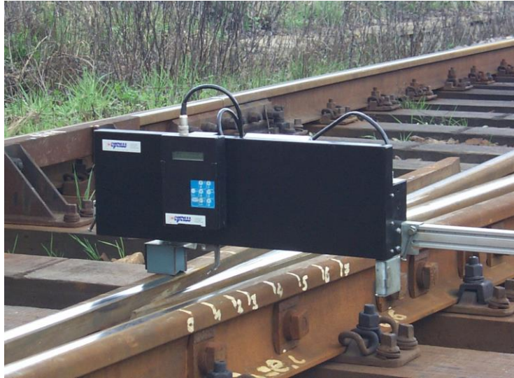
Profilomierz mechaniczny do szyn i rozjazdów (1997)
