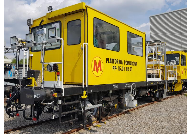
Polska – pojazd pomiarowy do torów i rozjazdów
