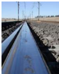
Ausbröckelungen und RCF an Backenschienen
