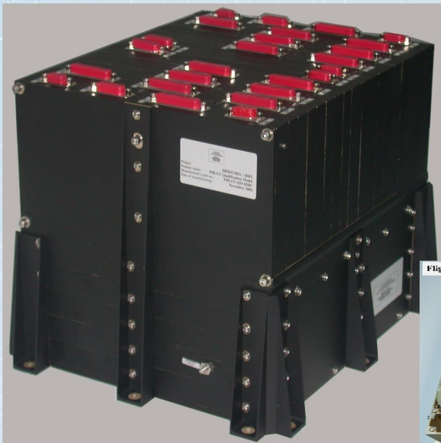
Na zdjęciu model lotny zaawansowanego systemu zasilania układu Lokalnego Oscylatora instrumentu HIFI.
