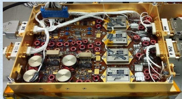
Na zdjęciu model lotny zasilacza instrumentu CaSSIS
