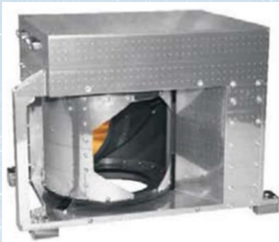
Na zdjęciu model lotny skanera przeznaczanego dla instrumentu PFS w misji Venus Express.
