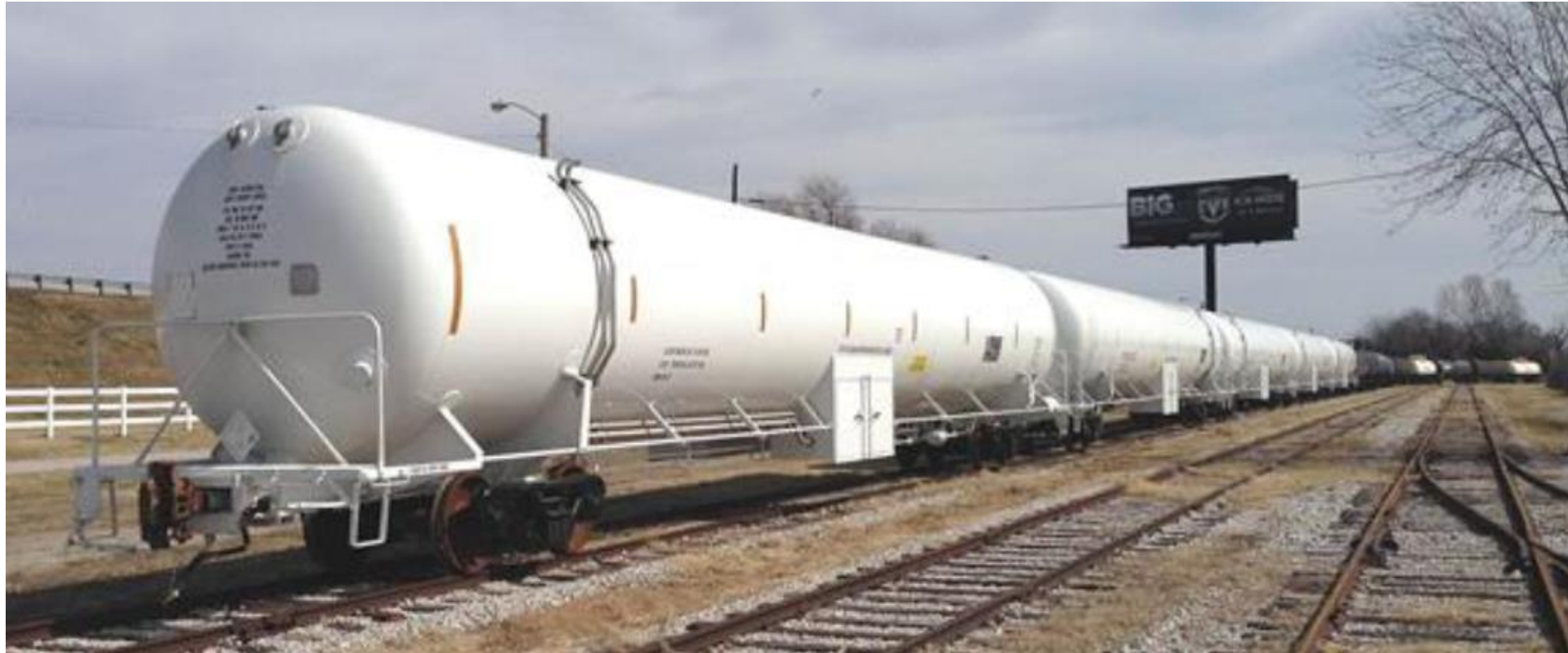
Rys. 12. Cysternach o specyfikacji DOT-113C120W przeznaczone do przewozu skroplonego etylenu oraz „innej łatwopalnej cieczy kriogenicznej, która ma podobne właściwości chemiczne i operacyjne jak LNG”. Zbiorniki mogą być wykonane ze stali węglowej, stopu aluminium, stali wysokostopowej lub stali niklowej poprzez spawanie.
