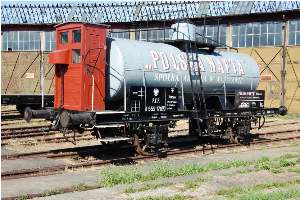
Rys. 5. Zbiornik – C. Domrandt, rok produkcji 1905; cysterna, dwuosiowy, hamulcowy z budką
