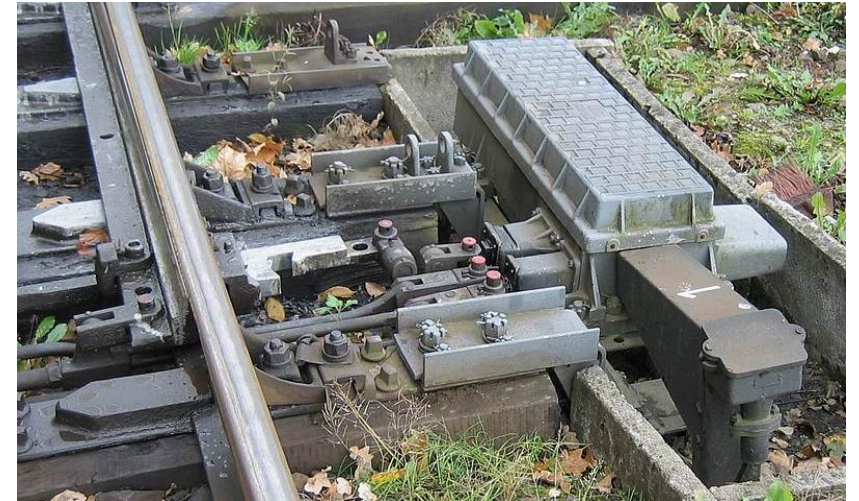
Umocowanie elektrycznego napędu zwrotnicowego typu EEA-4 przy torze
