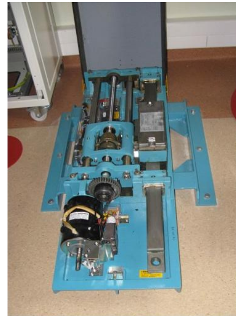
Widok elektrycznego napędu zwrotnicowego typu EEA-5 zainstalowanego w Laboratorium Systemów Sterowania Ruchem Kolejowym w UTH Radom
