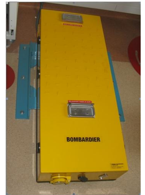
Widok elektrycznego napędu zwrotnicowego typu EEA-5 zainstalowanego w Laboratorium Systemów Sterowania Ruchem Kolejowym w UTH Radom
